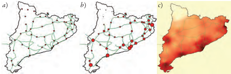
FIGURA 9a. Imatges de la xarxa de comunicacions interpretada amb nodes i arestes. FIGURA 9b. Representació de la xarxa amb la mida dels nodes depenent del seu valor. FIGURA 9c. Imatge de la comunicativitat dels nodes a Catalunya (color fosc = alta comunicativitat).
